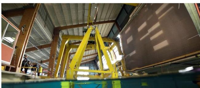
Essais d’une maquette d’éolienne flottante EOLINK au bassin d’essais du Centre Ifremer Bretagne
